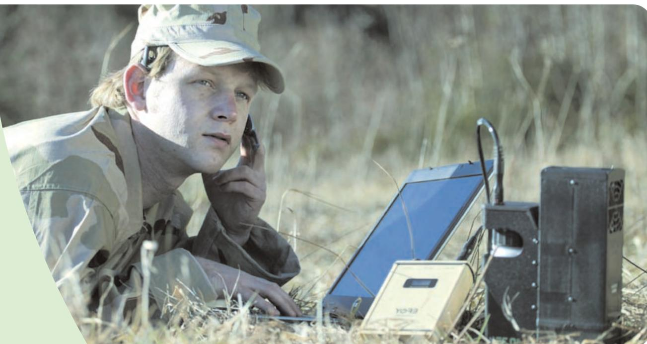
Jenny-Brennstoffzelle und Power Manager – die mobile Stromversorgung im Feld
